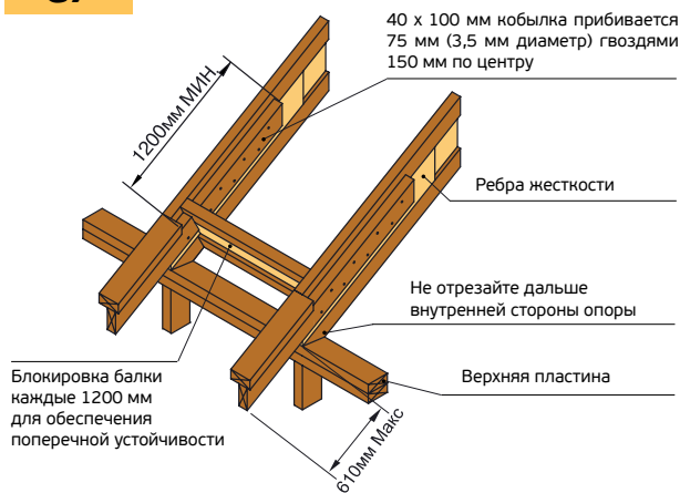
C7 УСТРОЙСТВО КОБЫЛКИ ДЛЯ УКЛОНОВ БОЛЕЕ 30
